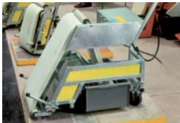
Fig 4.53 Maskin för upptagning av bruk och rengöring efter fogning.
