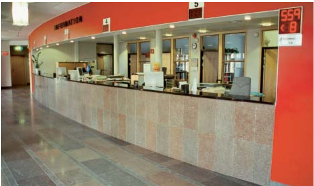
Fig 6.19 Reception med golv och diskfront i finlipad kalksten. Bänkskiva av polerad diabas.
